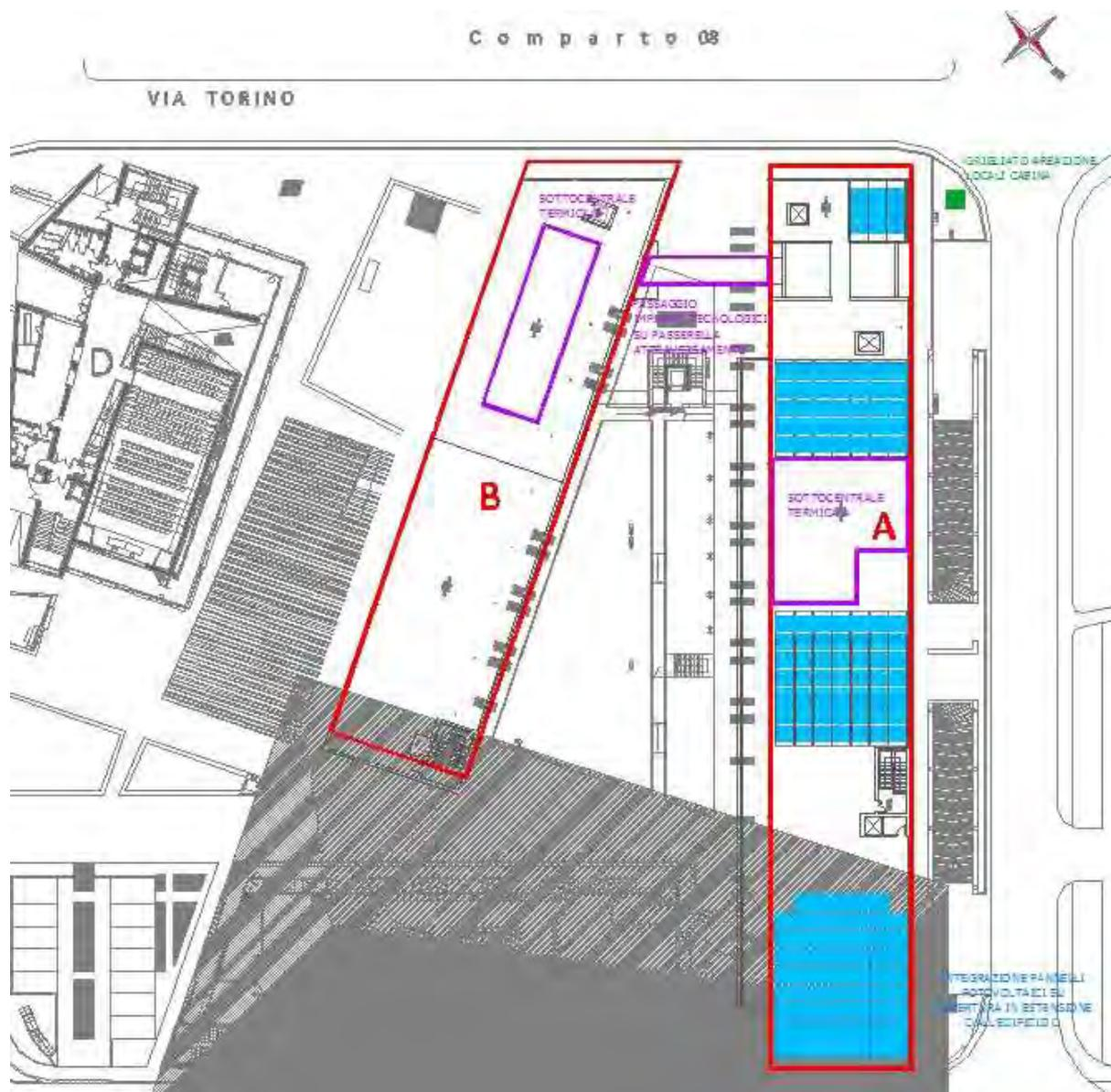
Utilizzando un pannello policristallino da 270W posato su una griglia di copertura si otterrebbe un impianto con **potenza di picco pari a circa 82,16 kilowatt nominali** (previsti attualmente 308 pannelli fotovoltaici).
